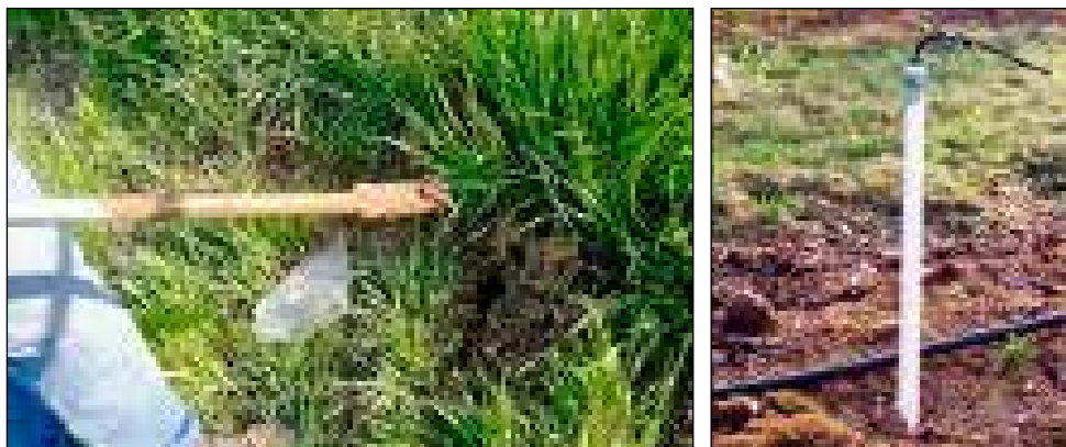
Fig. 9. Monitoraggio della disponibilità di nutrienti nel terreno mediante carotaggio del suolo (sinistra) o prelievo della soluzione con lisimetro a suzione (destra).
