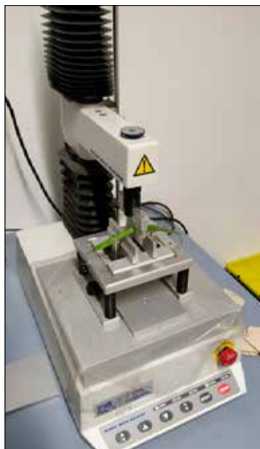
Fig. 14. – Analisi della struttura dei prodotti tramite dinamometro Stable Microsystem "TA-XT-PLUS".
