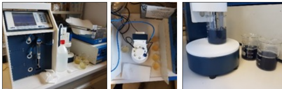
Fig. 11. Analisi dell'acidità titolabile con titolatore e sonda pH immersa nel campione.
